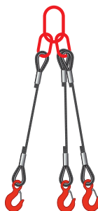
3СК- строп канатный трехветвевой
